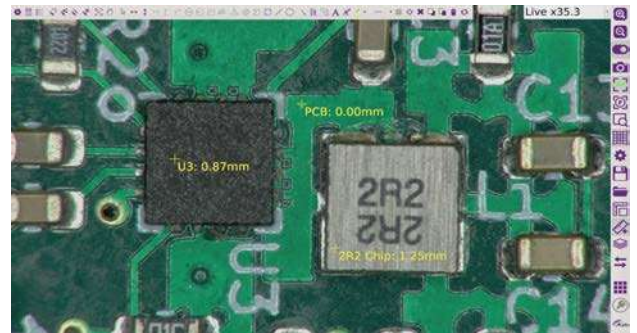
Mesure de la hauteur d'un composant avec l'App Axe Z de l'Omni 3
