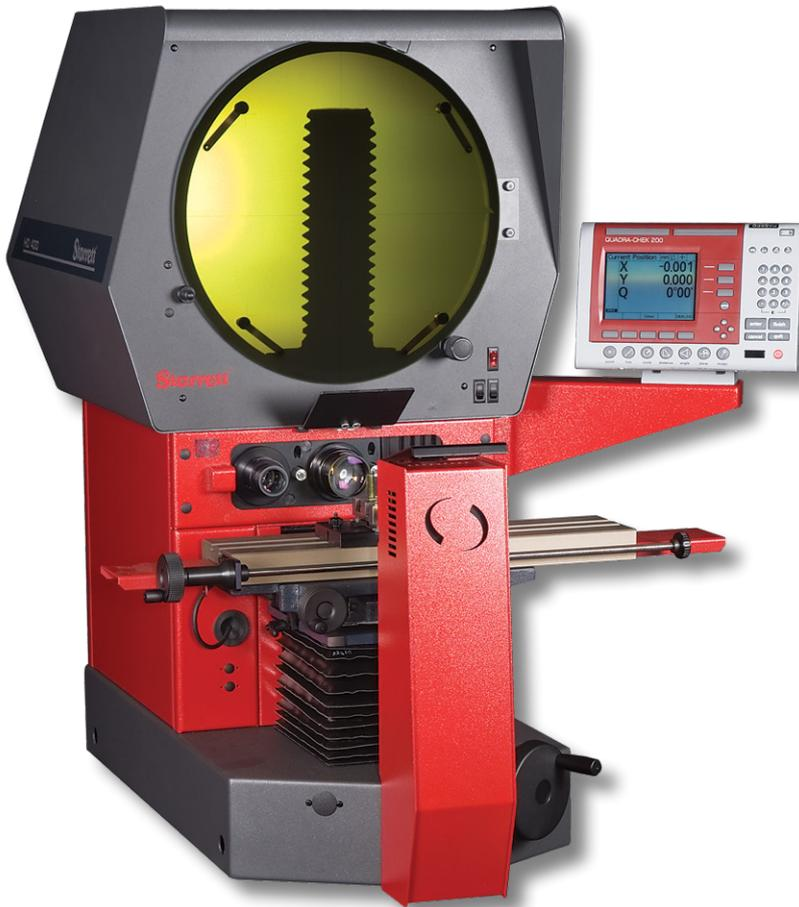
Projecteur de table sur axe horizontal, robuste et compact, le HD400 offre une image verticalement corrigée sur un écran entièrement utilisable de 400 mm de diamètre. Grâce à sa capacité largement supérieure, ce projecteur offre une gamme de mesures qui était jusqu'à présent uniquement disponible avec des appareils sur bâtis.
