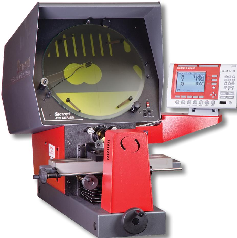
Pour améliorer la capacité et les performances, ce modèle combine un écran de 400 mm, une table de mesure avec déplacement de 250 mm sur X, des objectifs avec montage à baïonnette, un affichage angulaire sur l'axe Q.
