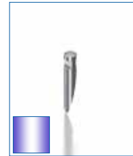
Tastspitze 33 mm Bestell-Nr.: 101-010-330 aus Hartmetall gefertigt, \varnothing 3,5 mm / R: 25 \mu m / W: 12°
