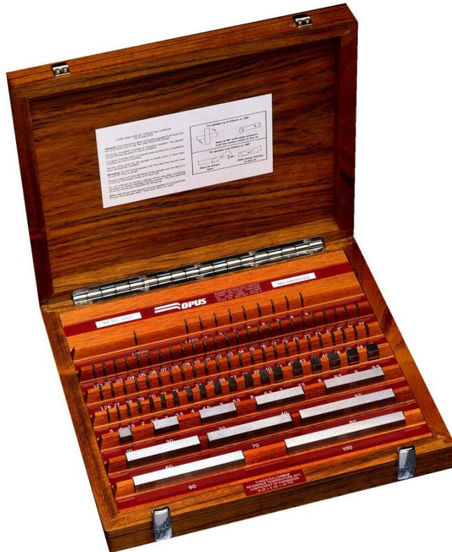
Sorgfältig ausgewählte Materialien von einer Härte von 1500 Hv garantieren höchste Genauigkeit, Stabilität und Oberflächenfinish.
