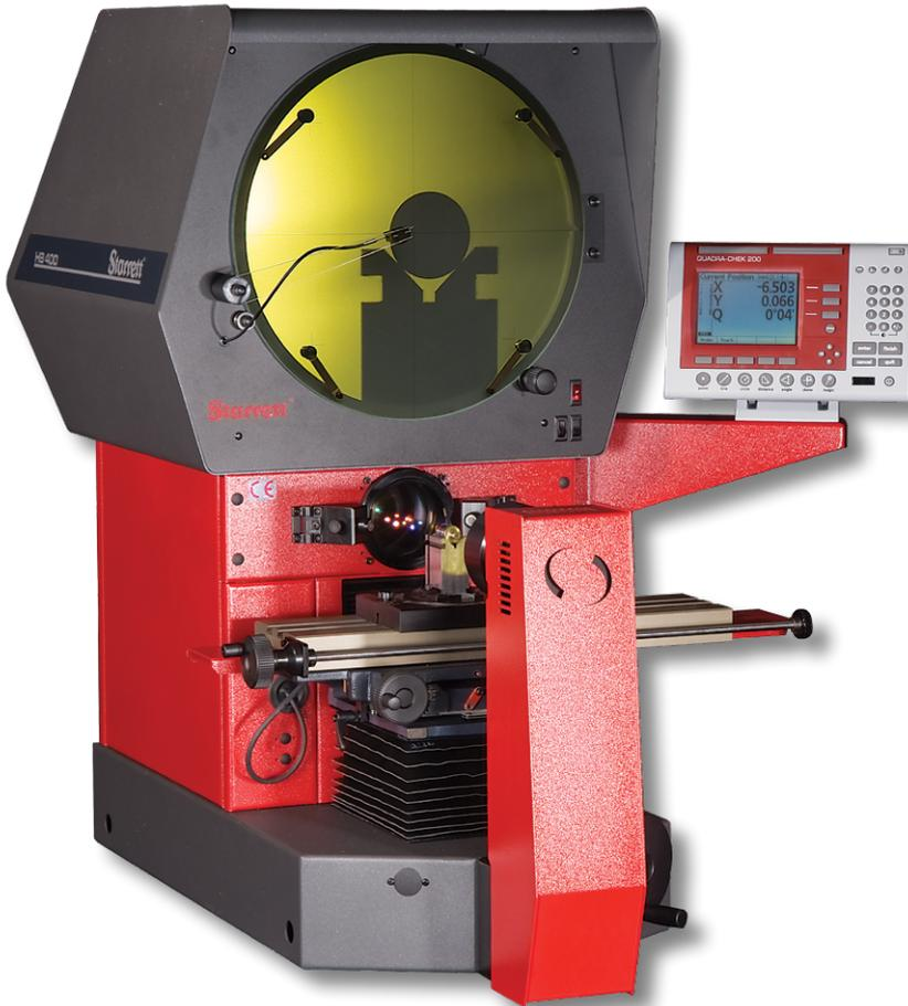
Der HB400 liefert ein vertikal seitenrichtiges Bild auf einem vollständig nutzbaren 400 mm (16") Bildschirm. Mit seinem bedeutend größeren Messvolumen ermöglicht dieser Projektor Messungen, die bislang nur bei bodenstehenden Geräten möglich waren.
