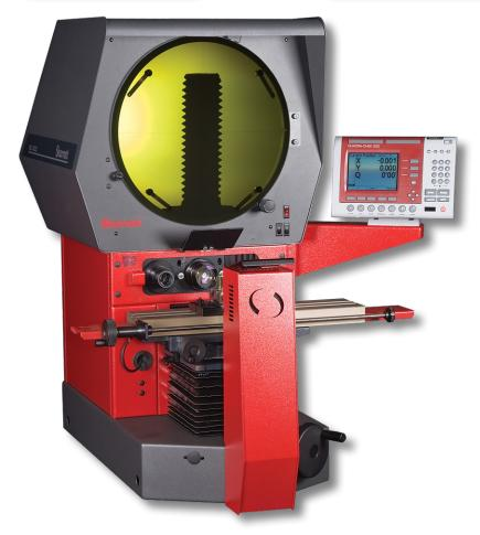
Der robuste, kompakte Horizontalachsen-Tischprojektor HD400 liefert ein vertikal seitenrichtiges Bild auf einem vollständig nutzbaren 400 mm (16") Bildschirm. Mit seinem bedeutend größeren Messvolumen ermöglicht dieser Projektor Messungen, die bislang nur bei bodenstehenden Geräten möglich waren.
